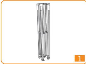
Das Pavillongestell aus der Transporttasche ziehen und mit den Füßen nach unten aufstellen. Die Bespannung (Dachplane) ist bereits am Pavillongestell befestigt (nicht im Bild) und bleibt dort auch beim Abbau. **[Bild 1]**
