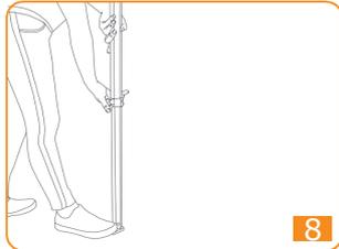
Um die Höhe des Pavillons zu verstellen, werden die Füße herausgezogen [Bild 7] bis sie einrasten. Es gibt verschiedene Höheneinstellungen. Mithilfe der roten Hebel lässt sich die Höhe variieren. [Bild 8]
